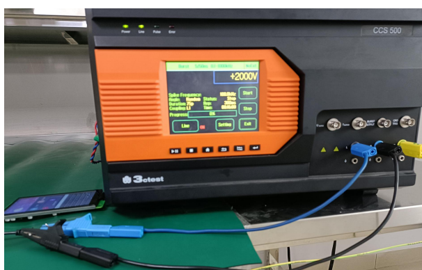
3.2 群脉冲测试图 EFT test
