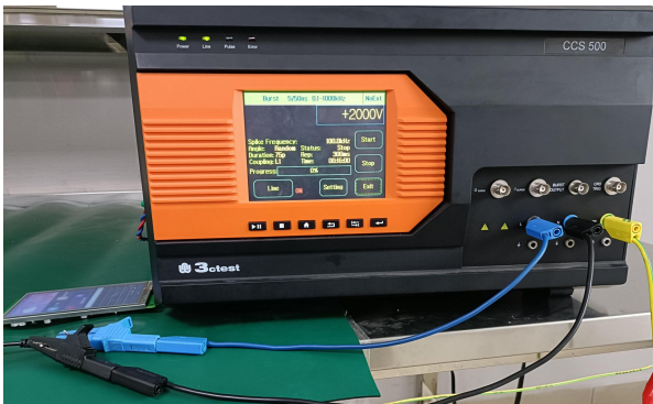
3.2 群脉冲测试图 EFT test
