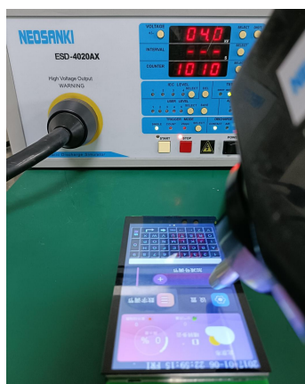
3.1 静电放电测试图 Electrostatic discharge test
