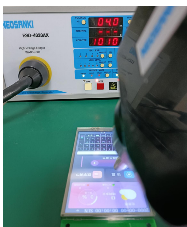
3.1 静电放电测试图 Electrostatic discharge test
