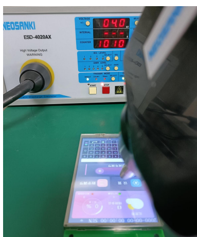
3.1 静电放电测试图 Electrostatic discharge test
