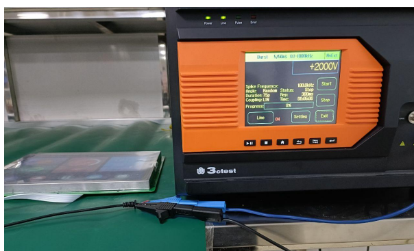
3.2 群脉冲测试图 EFT test
