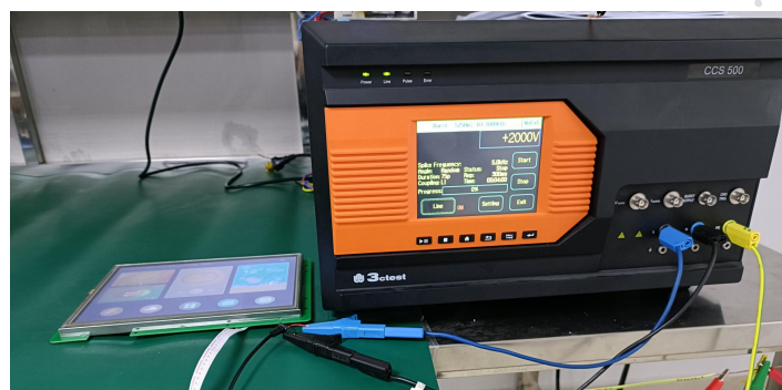
3.2 群脉冲测试图 EFT test
