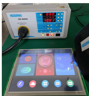
3.1 静电放电测试图 Electrostatic discharge test
