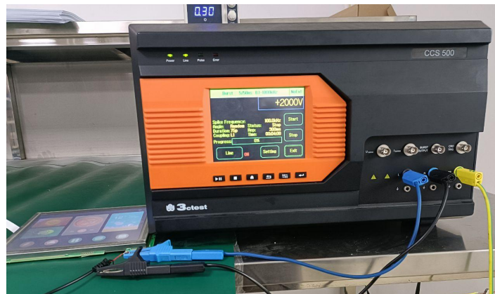
3.2 群脉冲测试图 EFT test
