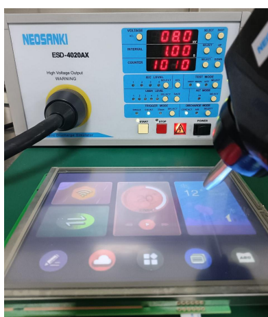
3.1 静电放电测试图 Electrostatic discharge test
