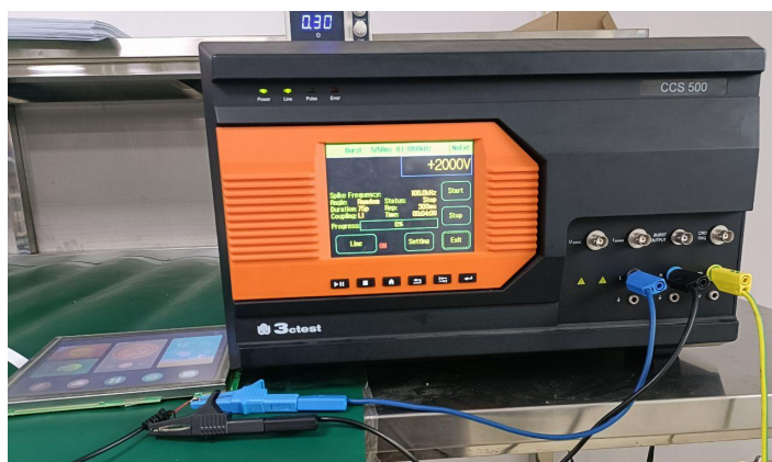
3.2 群脉冲测试图 EFT test
