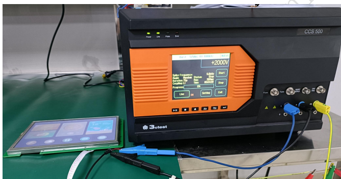
3.2 群脉冲测试图 EFT test
