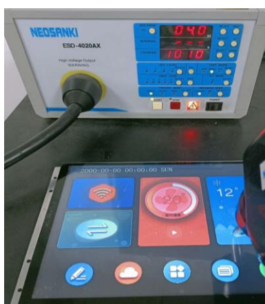
3.1 静电放电测试图 Electrostatic discharge test
