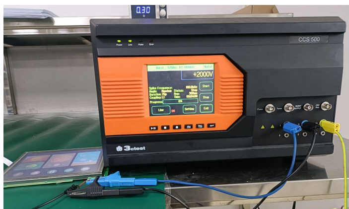
3.2 群脉冲测试图 EFT test
