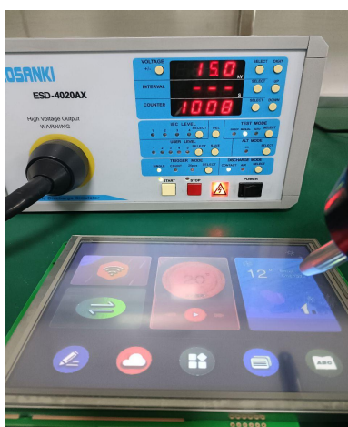
3.1 静电放电测试图 Electrostatic discharge test
