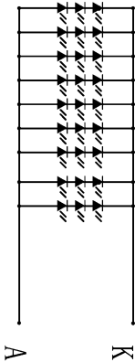
电路图: 3串9并=27LED
