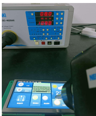
3.1 静电放电测试图 Electrostatic discharge test
