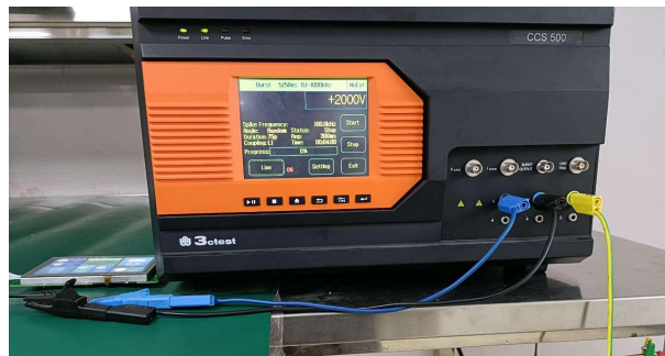
3.2 群脉冲测试图 EFT test
