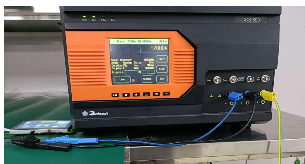
3.2 群脉冲测试图 EFT test
