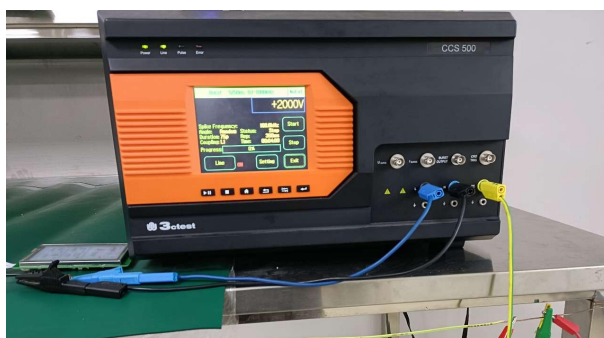
3.2 群脉冲测试图 EFT test
