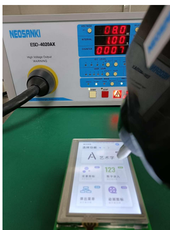
3.1 静电放电测试图 Electrostatic discharge test
