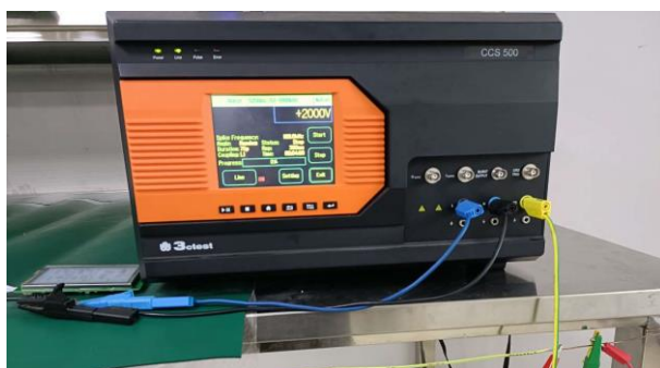
3.2 群脉冲测试图 EFT test
