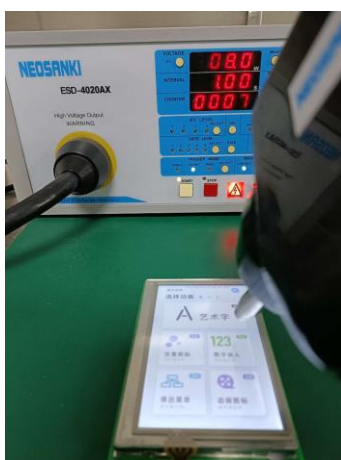
3.1 静电放电测试图 Electrostatic discharge test
