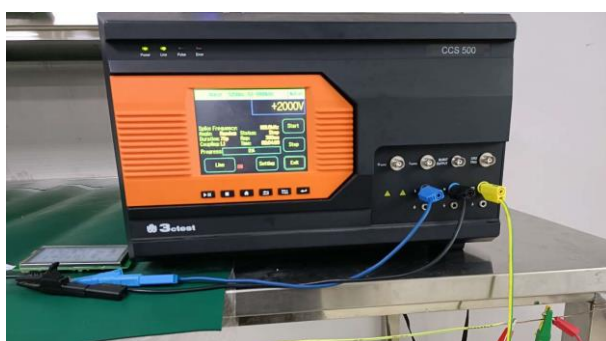
3.2 群脉冲测试图 EFT test
