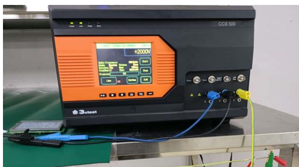
3.2 群脉冲测试图 EFT test
