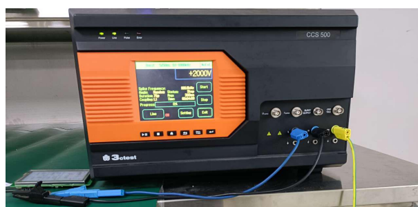
3.2 群脉冲测试图 EFT test
