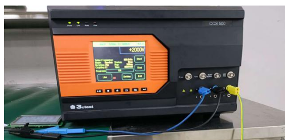
EFT test
