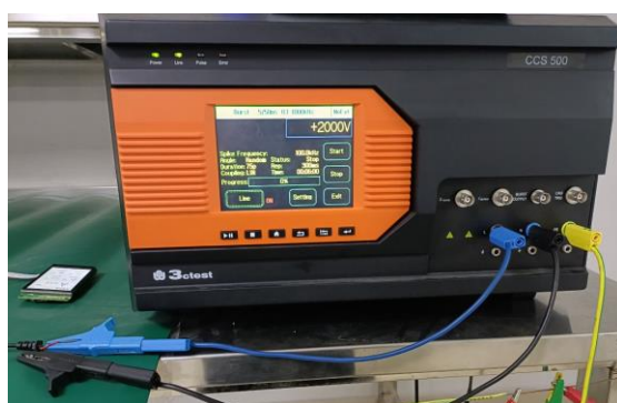
3.2 群脉冲测试图 EFT test
