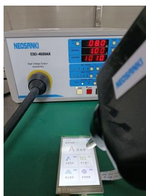
3.1 静电放电测试图 Electrostatic discharge test
