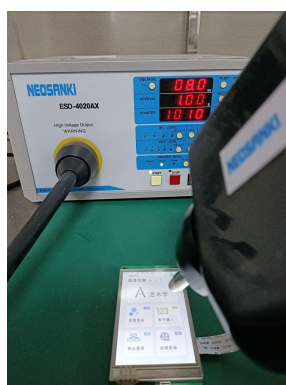
3.1 静电放电测试图 Electrostatic discharge test
