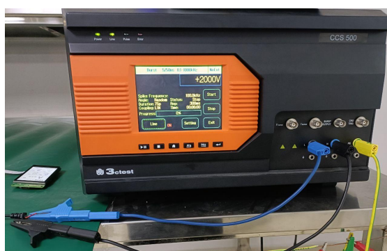
3.2 群脉冲测试图 EFT test
