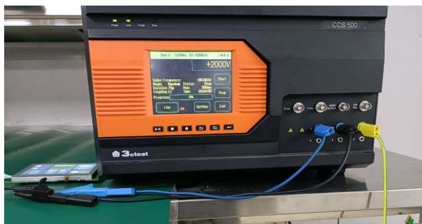
3.2 群脉冲测试图 EFT test
