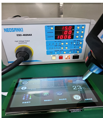
3.1 静电放电测试图 Electrostatic discharge test
