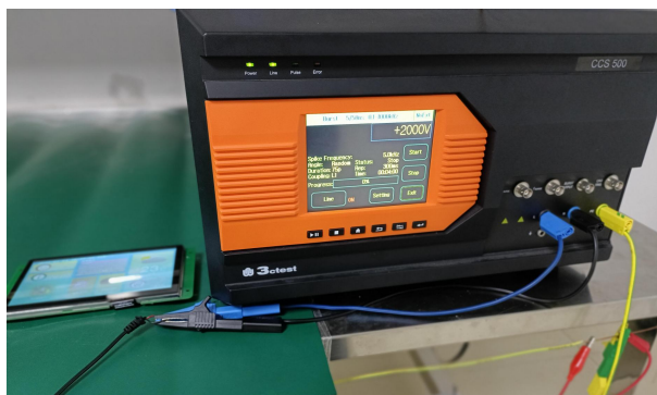
3.2 群脉冲测试图 EFT test
