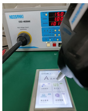
3.1 静电放电测试图 Electrostatic discharge test
