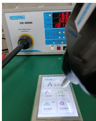
3.1 静电放电测试图 Electrostatic discharge test
