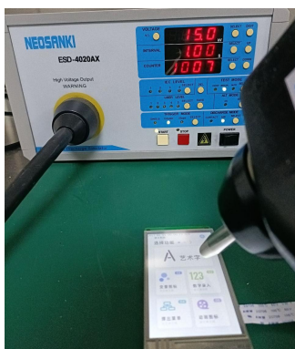
3.1 静电放电测试图 Electrostatic discharge test
