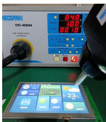
3.1 静电放电测试图 Electrostatic discharge test
