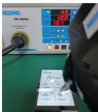
3.1 静电放电测试图 Electrostatic discharge test
