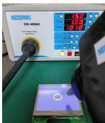
3.1 静电放电测试图 Electrostatic discharge test
