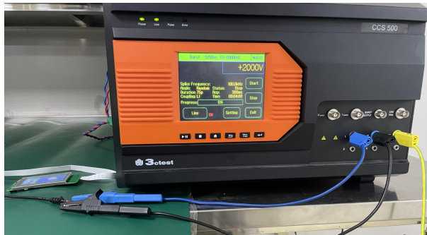
3.2 群脉冲测试图 EFT test
