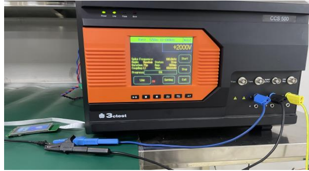
3.2 群脉冲测试图 EFT test
