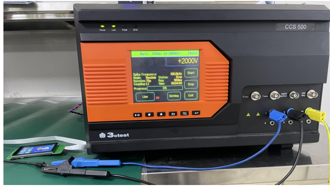
3.2 群脉冲测试图 EFT test
