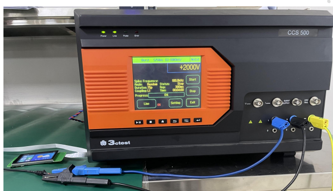
3.2 群脉冲测试图 EFT test
