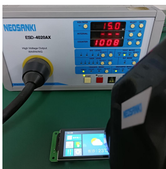
3.1 静电放电测试图 Electrostatic discharge test
