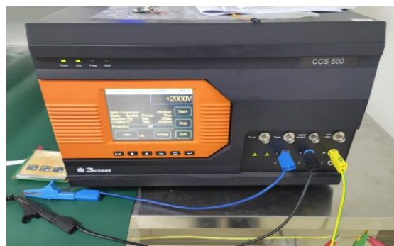
3.2 群脉冲测试图 EFT test
