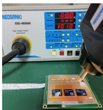
3.1 静电放电测试图 Electrostatic discharge test
