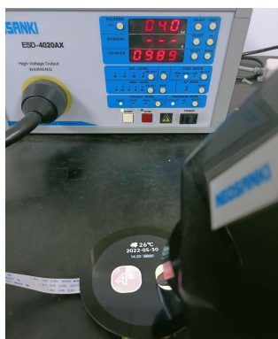
3.1 静电放电测试图 Electrostatic discharge test
