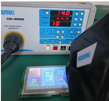
3.1 静电放电测试图 Electrostatic discharge test
