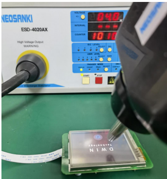
3.1 静电放电测试图 Electrostatic discharge test
