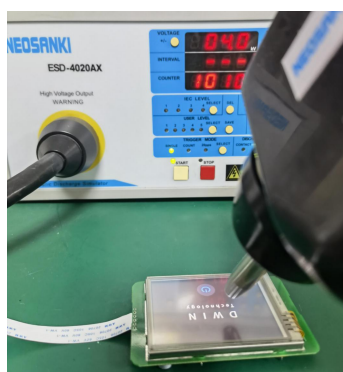
3.1 静电放电测试图 Electrostatic discharge test
