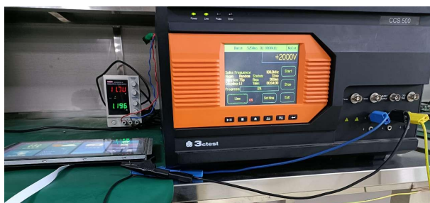
3.2 群脉冲测试图 EFT test
