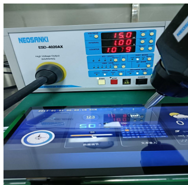
3.1 静电放电测试图 Electrostatic discharge test
