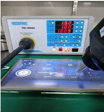
3.1 静电放电测试图 Electrostatic discharge test
