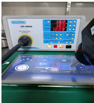
3.1 静电放电测试图 Electrostatic discharge test
