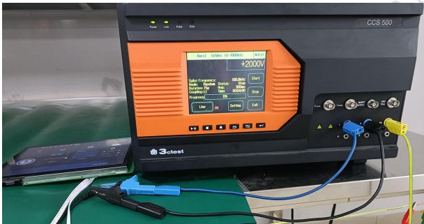
3.2 群脉冲测试图 EFT test
