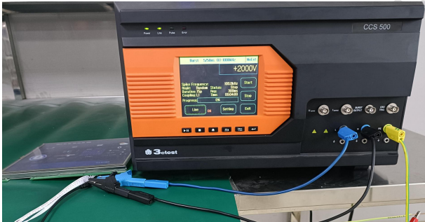
3.2 群脉冲测试图 EFT test
