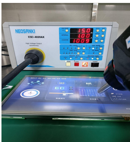
3.1 静电放电测试图 Electrostatic discharge test
