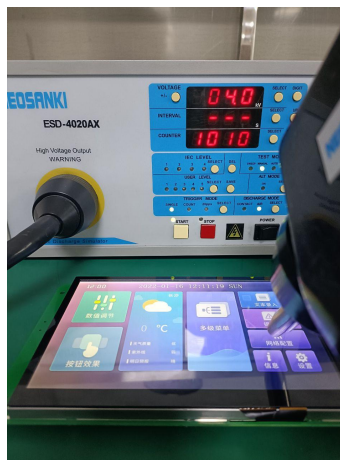
3.1 静电放电测试图 Electrostatic discharge test
