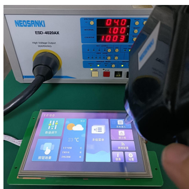
3.1 静电放电测试图 Electrostatic discharge test
