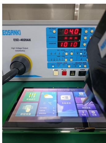
3.1 静电放电测试图 Electrostatic discharge test
