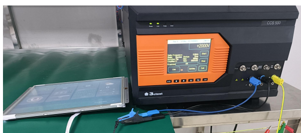
3.2 群脉冲测试图 EFT test
