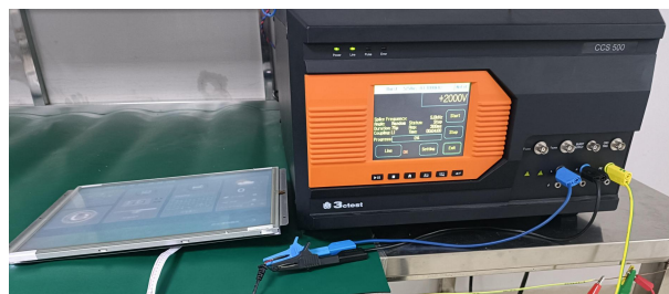
3.2 群脉冲测试图 EFT test
