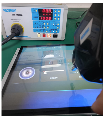
3.1 静电放电测试图 Electrostatic discharge test
