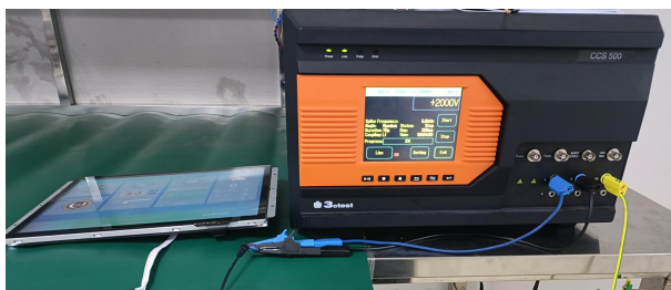
3.2 群脉冲测试图 EFT test
