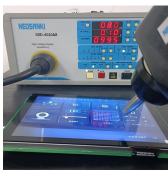
3.1 静电放电测试图 Electrostatic discharge test
