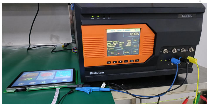
3.2 群脉冲测试图 EFT test
