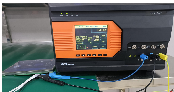
3.2 群脉冲测试图 EFT test
