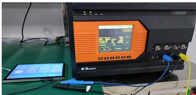
3.2 群脉冲测试图 EFT test
