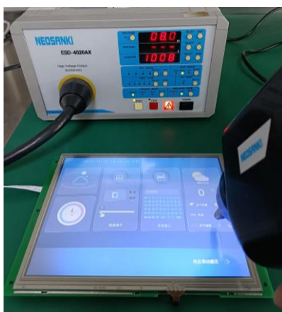
3.1 静电放电测试图 Electrostatic discharge test
