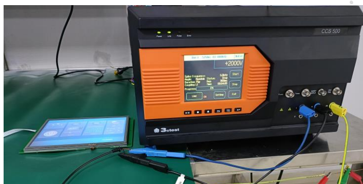
3.2 群脉冲测试图 EFT test
