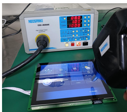
3.1 静电放电测试图 Electrostatic discharge test
