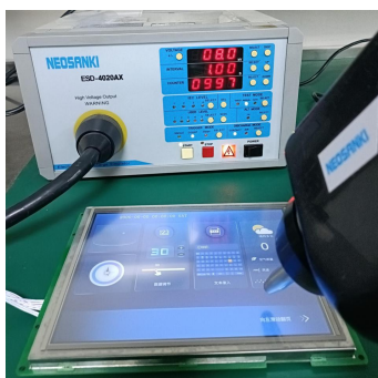
3.1 静电放电测试图 Electrostatic discharge test
