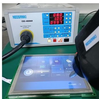
3.1 静电放电测试图 Electrostatic discharge test
