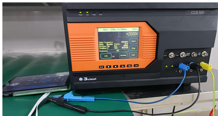
3.2 群脉冲测试图 EFT test
